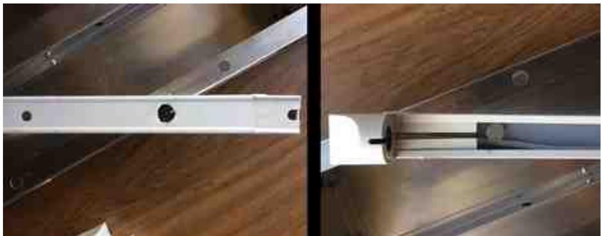
FIGURA 25 (agujero para alimentación de tubo UV inferior)
