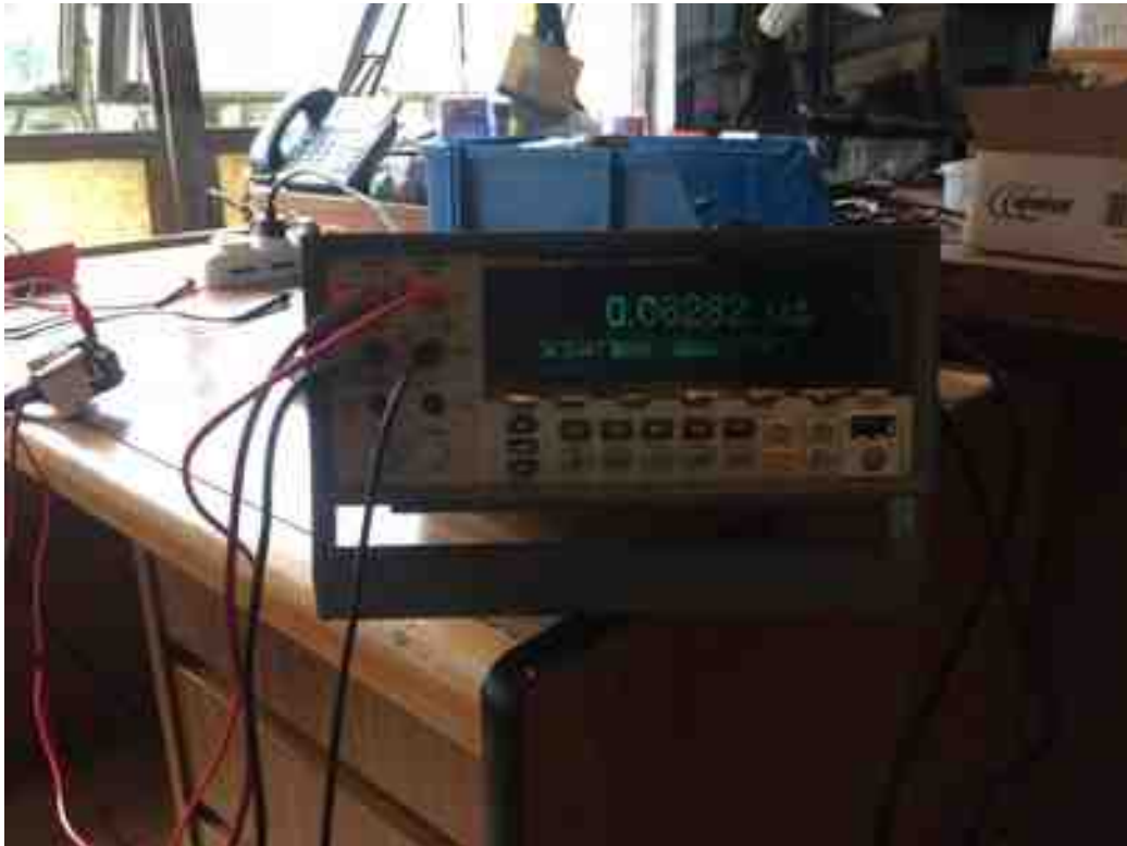
FIGURA 9 (resistencia desde terminal de tierra de toma-corriente a puerta)
