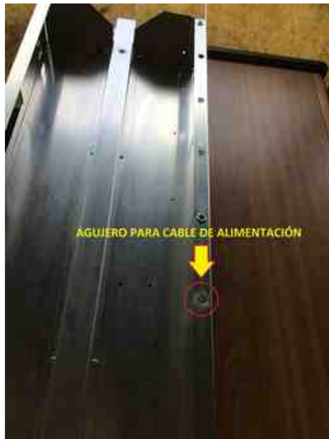
FIGURA 24 (agujero para pasar cable de alimentación de tubos UV superiores)
