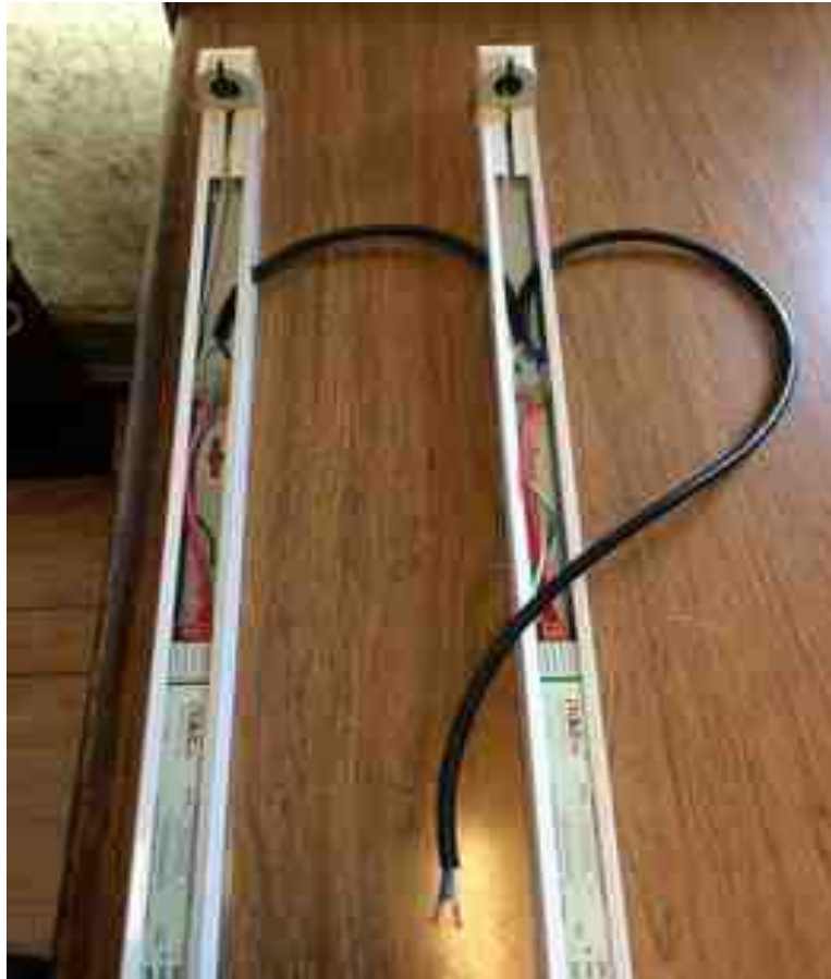
FIGURA 26 (agujeros para alimentación de tubos UV superiores)
