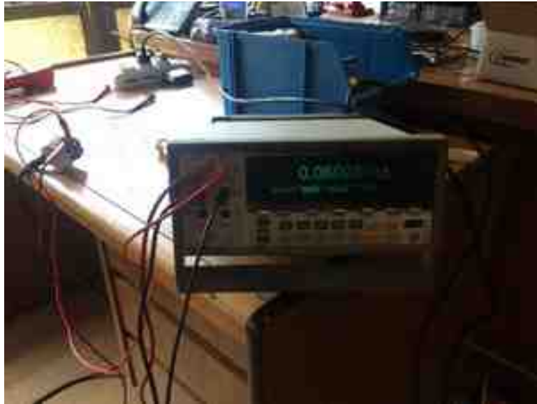
FIGURA 7 (resistencia desde terminal de tierra de toma-corriente a carcasa)
