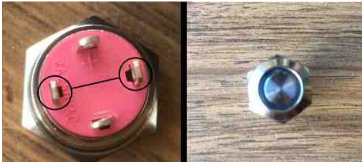
FIGURA 16 (las terminales del pulsador utilizadas se encuentran marcadas por un círculo negro)
